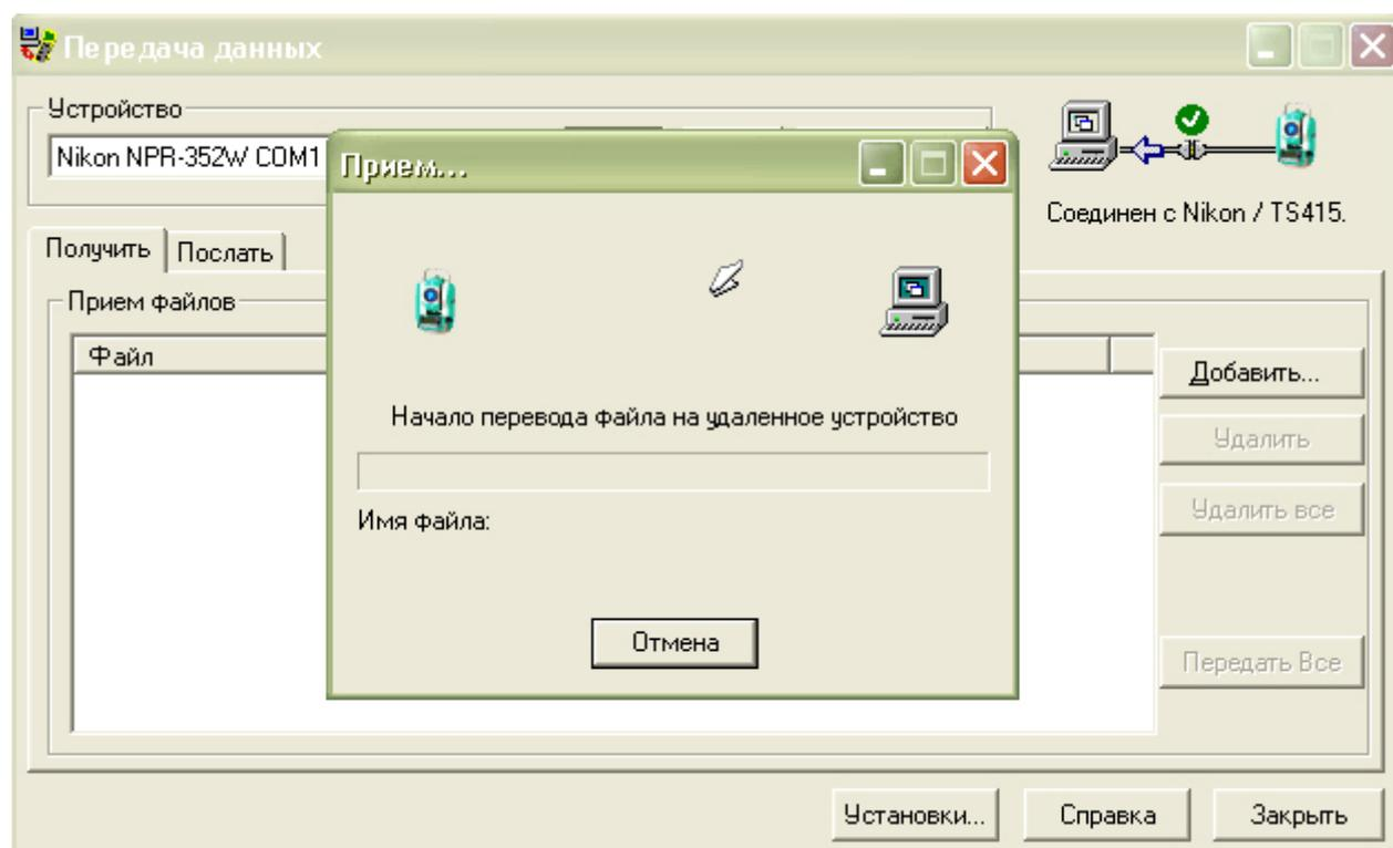
А в тахеометре нажимаем REC/ENT. Начнется передача данных. После передачи, тахеометр спросит об удалении переданного файла. Ждем «Отмена» для сохранения данных в приборе.
