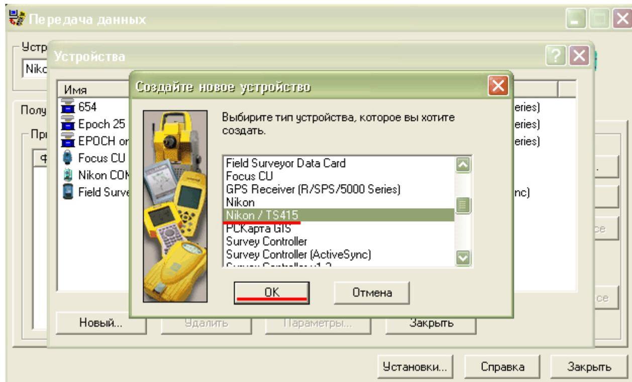
Выбираем COM-порт к которому будем присоединять тахеометр. «Далее».
