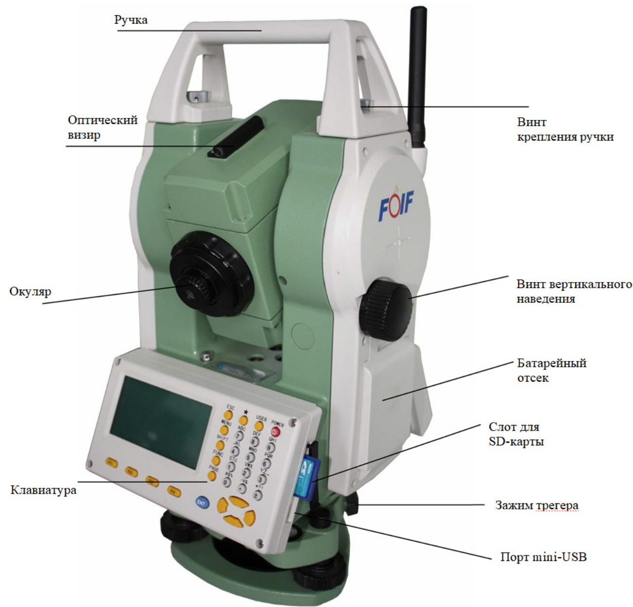
Рисунок 3 - Основные элементы тахеометров FOIF в модификациях RTS332N и RTS342N (задняя панель)
